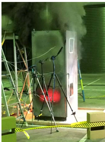
鉛蓄電池延焼状況④
