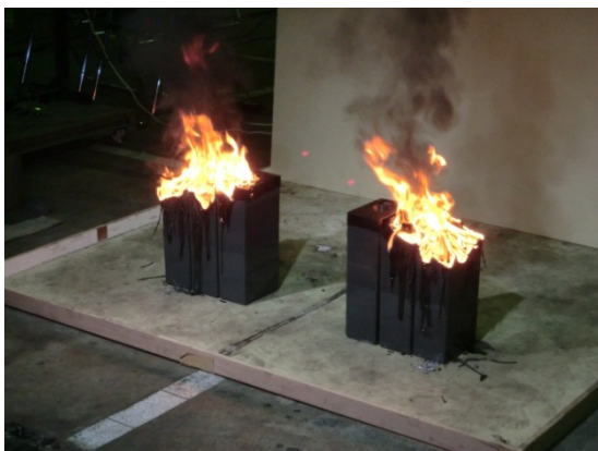
充電状態電池 放電状態電池
