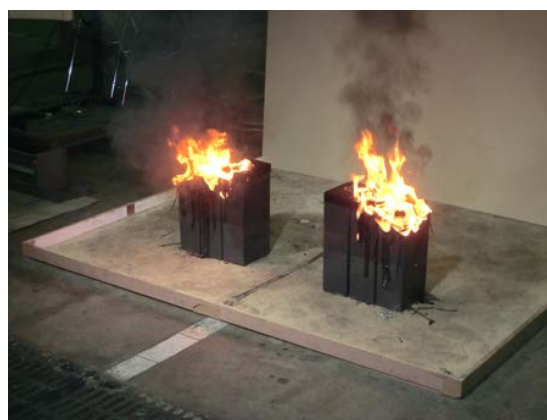
充電状態電池 放電状態電池
