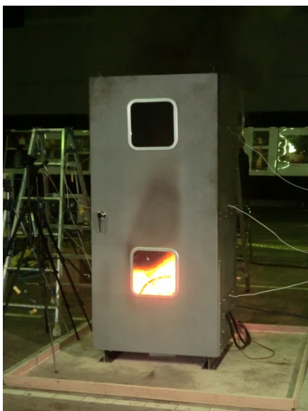
鉛蓄電池延焼状況③
