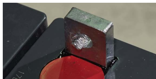
実験後（端子の一部が溶融）
