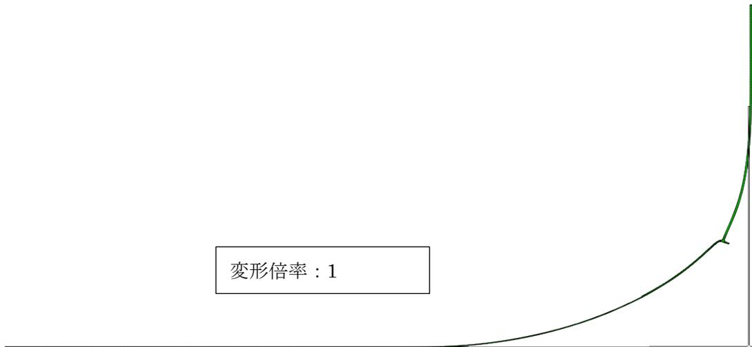
図4.2.1.6 浮き上がり時の隅角部の変形図(サイクル13回目の浮き上がり時)
