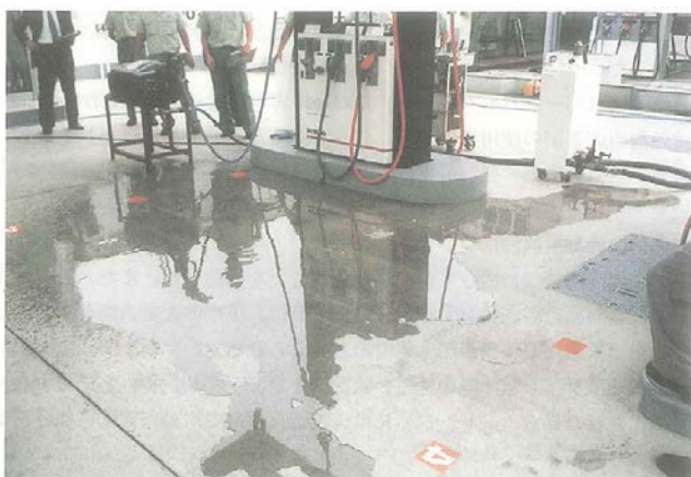
図2 給油ノズル・満量停止装置の故障時の噴出漏えい状況（10リットル漏えい時） （床面の赤いマークの間隔は1メートル） 4)
