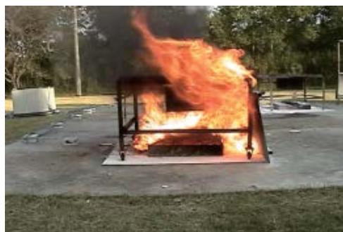
図6 90cm×100cmのガソリン火炎により高圧ガス容器を加熱している様子
