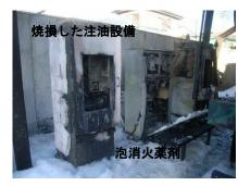
移動タンク貯蔵所 から給油取扱所に 単独荷卸し中、オンリンを流出取り がソリンを流出と がソリンを流の原と で着火したことに よる火災
