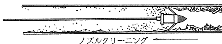
図-7.5.58 ジェット工法の例
