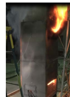
キュービクル外部への延焼拡大の検証
