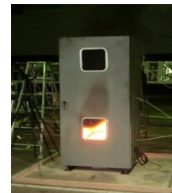
キュービクル外部への延焼拡大の検証
