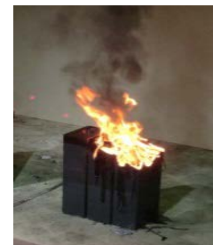
電池間の延焼危険の検証
