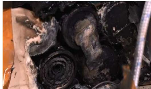
④実験後 (排出弁の破損状況)
