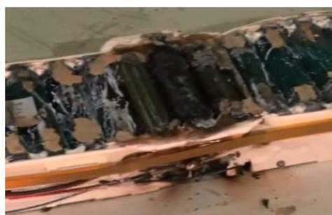
⑥実験後(裏面に電解液が付着)
