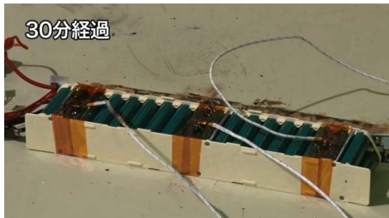
②表面温度 68.2℃ (最高温度)
