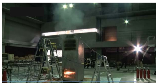
④キュービクル温度 491℃（最高温度）
