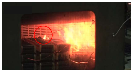
③隣接する蓄電池への延焼状況
