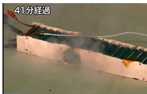
④表面温度 153.7℃（最高温度）
