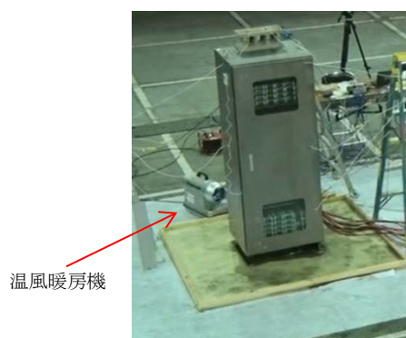
【キュービクル内の加温状況】
