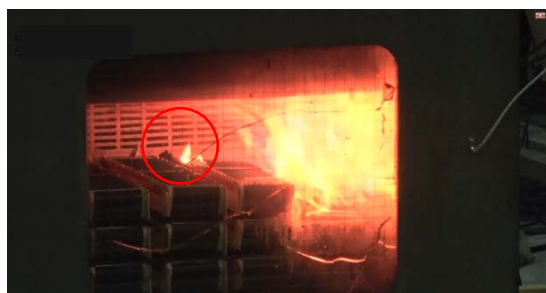
③隣接する蓄電池への延焼状況
