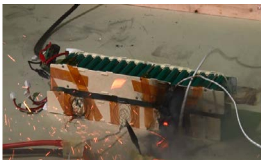
③排出弁作動 (風圧により消火)
