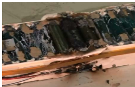
⑥実験後（裏面に電解液が付着）
