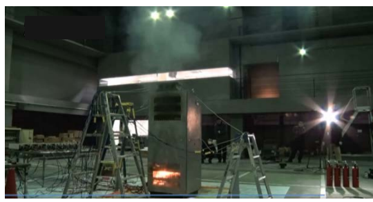
④キュービクル温度 491℃（最高温度）
