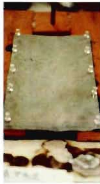
写真11-2 現用防火服地 (使用品、15度)
