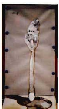
写真 9 現用防火服地 (新品、裏面、60度)
