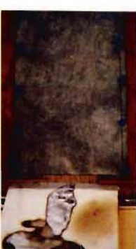
写真 10 - 1 現用防火服地 (使用品、45度)
