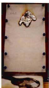
写真 8 - 2 現用防火服地 (新品、裏面、45度)
