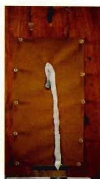
写真 3 - 1 新型防火服地 (新品、80度)
