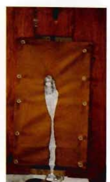
写真 3 - 2 新型防火服地 (新品、80度)
