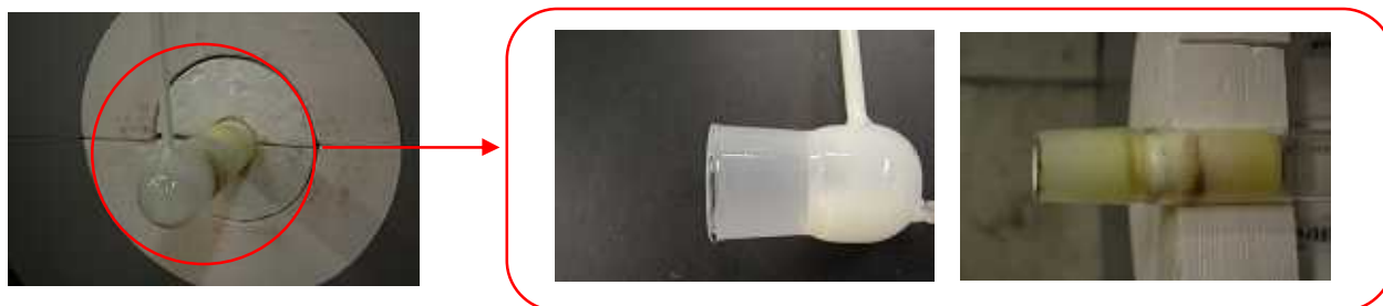
図25 加熱発生ガス試験終了後のガス流通経路の状況
