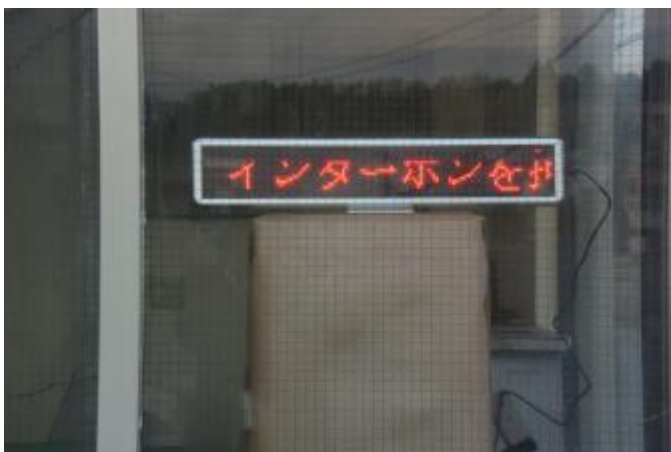
写真21 電光掲示板(屋内式／給油取扱所に設置)
