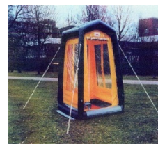
除染シャワー
