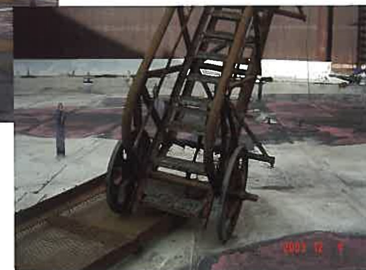
脱輪したローリングラダー
