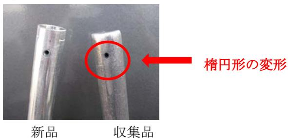
図 18 給油ノズルの目視結果
