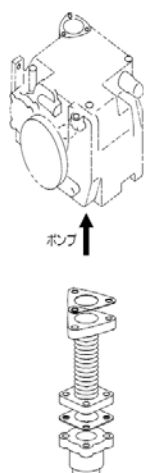
図 38 可とう管継手の構造例（提供：日本ガソリン計量機工業会）
