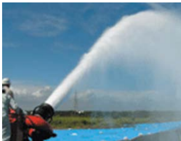
写真 1-2 大容量泡放射システム
