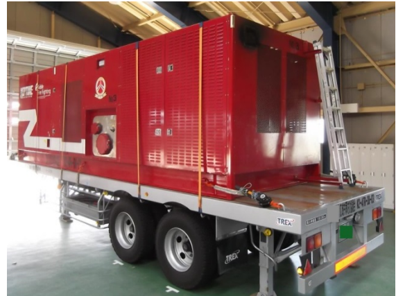
写真 2-12 一体型消防ポンプの保管状況
