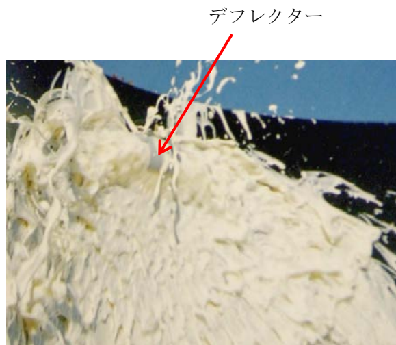
写真 3-1 II型泡放出口による泡放出状況 出典：深田工業株式会社カタログ
