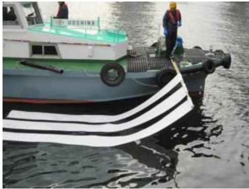
図8-8-6 ロール状吸着材曳航による極薄油膜の回収
