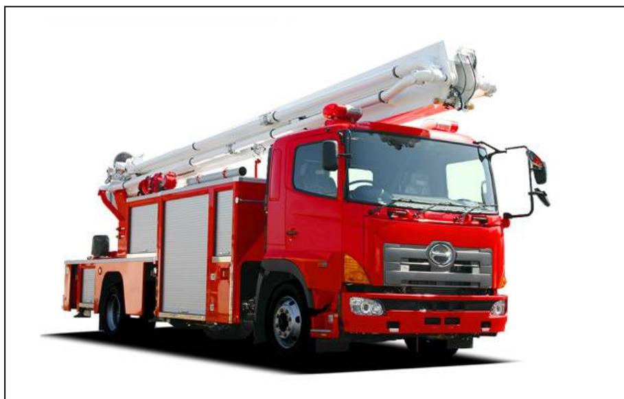
図 7 - 2 - 2 大型高所放水車
