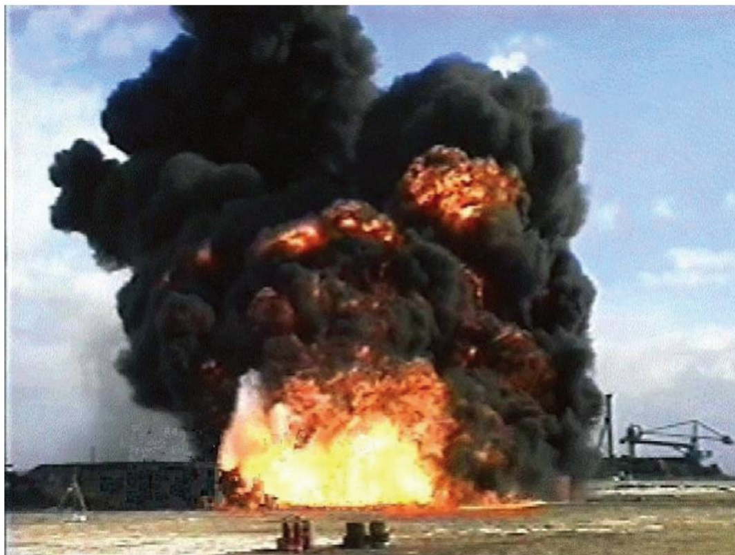
写真2-2-2 直径5メートルの容器を用いたボイルオーバー実験
