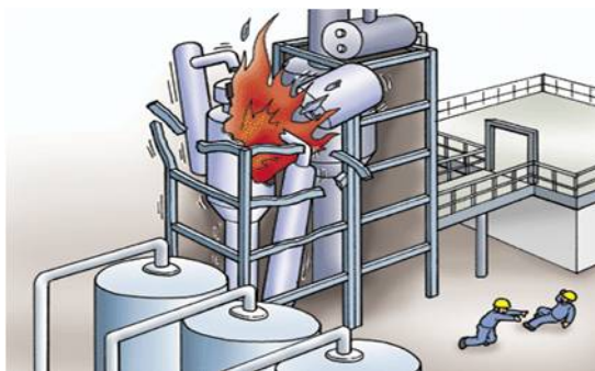
図 3-3-1 緊急停止により二次災害発生危険あり
