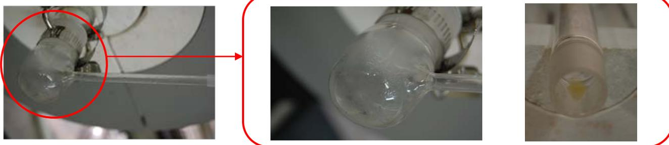
図 42 加熱発生ガス試験終了後のガス流通経路の状況(グリコール酸)
