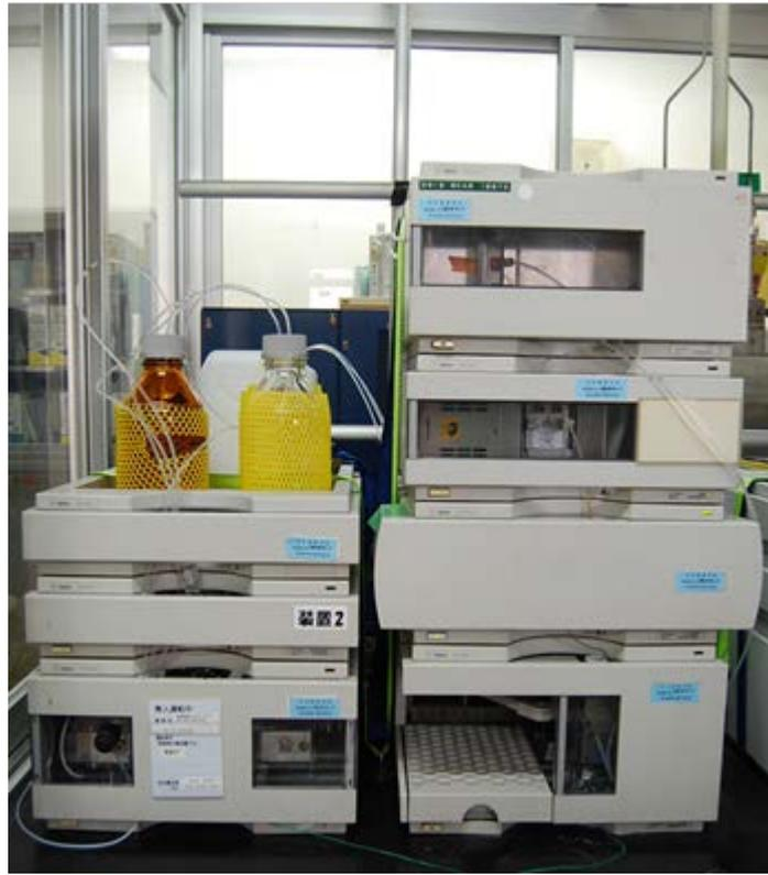
図 9 高速液体クロマトグラフ : Agilent 製 1100LC システム
