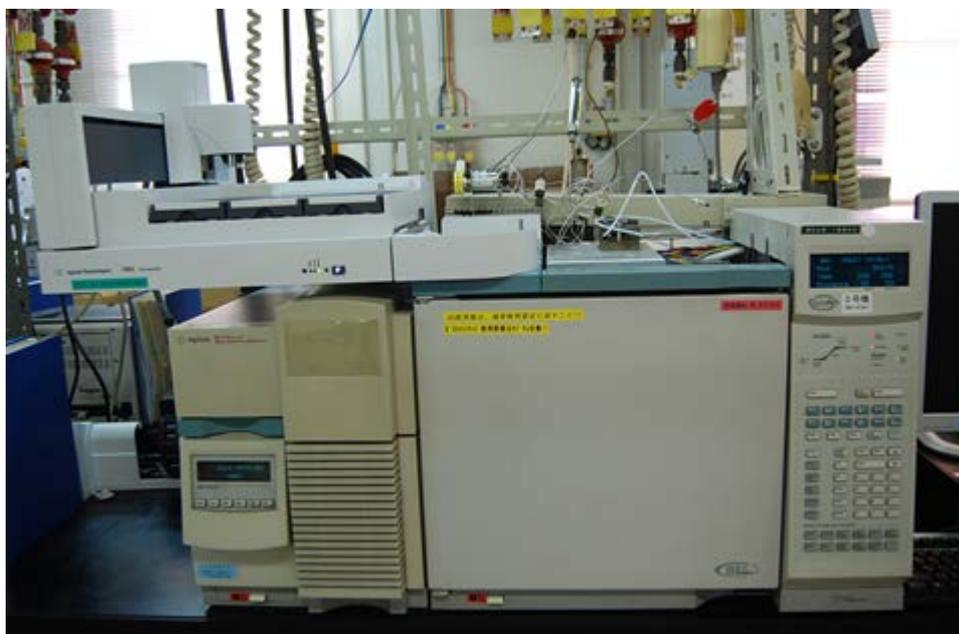
図 7 ガスクロマトグラフ質量分析計 : Agilent 製 6890A/5973N
