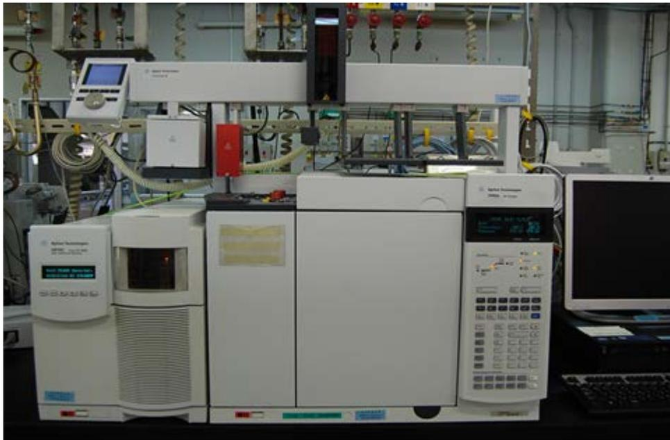
図 6 ガスクロマトグラフ質量分析計 : Agilent 製 7890A/5975C
