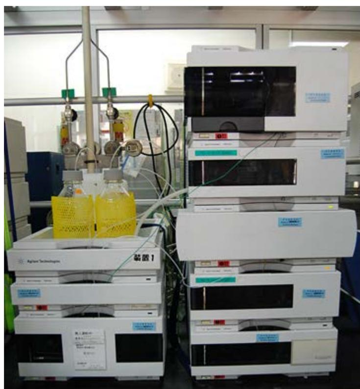
図 8 高速液体クロマトグラフ : Agilent 製 1200LC システム
