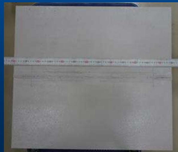
・深さ3mm × 長さ6mmの人工ノッチ・塗膜厚は700 $\mu$ m
