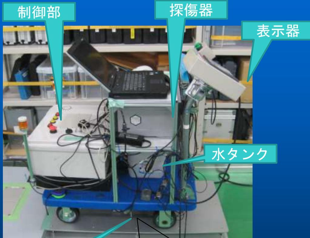
コーティングされた特定屋外貯蔵タンクの底板について、コーティングを剥ぐことなく、高感度の超音波探傷システムにより溶接部の欠陥を確認する装置。
