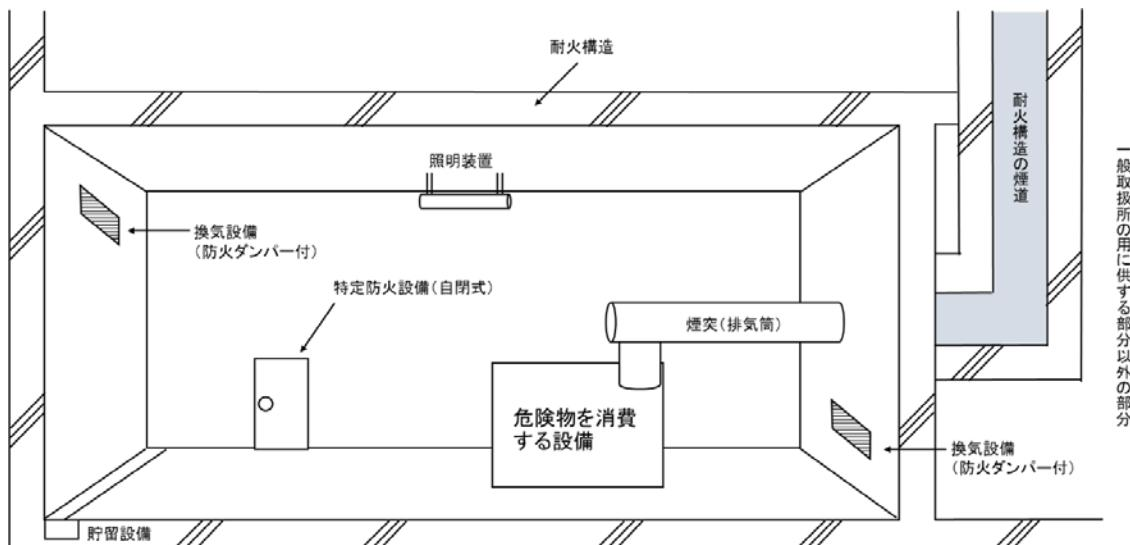
図 11 他の部分との区画壁に排気筒が貫通する場合の措置の例
