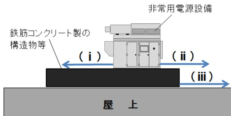
図3 鉄筋コンクリート製の構造物等の上に設置する非常用電源設備
