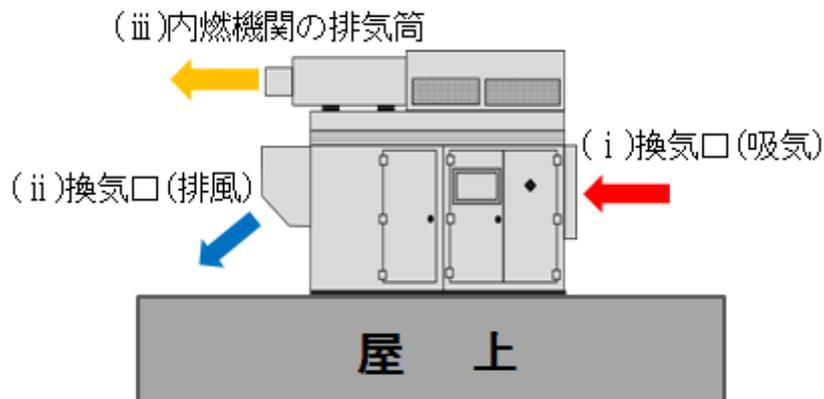
図1 非常用電源設備の吸排気に係る部分
