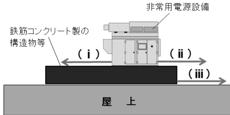
図6 鉄筋コンクリート製の構造物等の上に設置する非常用電源設備
