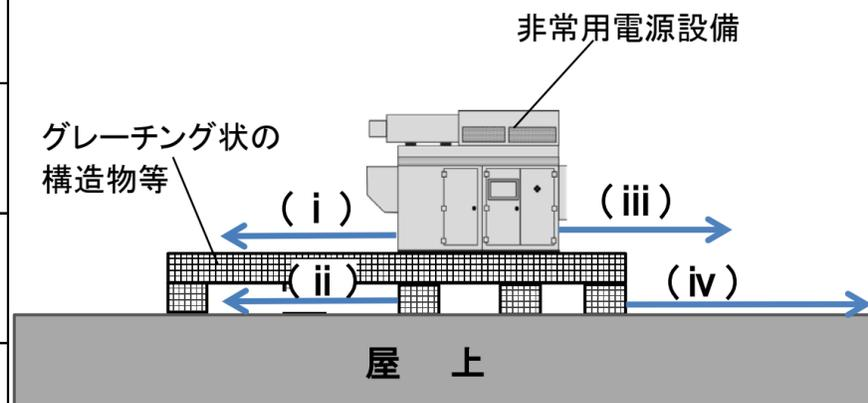
b. 屋上に設置された鉄筋コンクリート製の構造物等（危険物が浸透しないもの）の上に非常用電源設備を固定し設置する場合、保有空地の取り方について、どのように運用されていますか。下図を参考に選択して下さい。（複数選択可）
