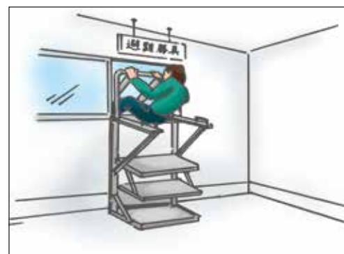
⑤身体を十分に伸ばし、両手は耳を保護する姿勢で上げ、足はまっすぐ伸ばして降下する。降下速度が速すぎた場合は、ひじ・ひざを曲げてブレーキをかける。(救助袋の構造によっては、ひじ・ひざを曲げてはいけないものもある。)
