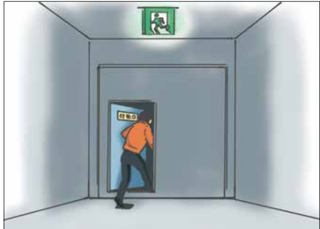
誘導標識が貼られたくぐり戸から避難する
