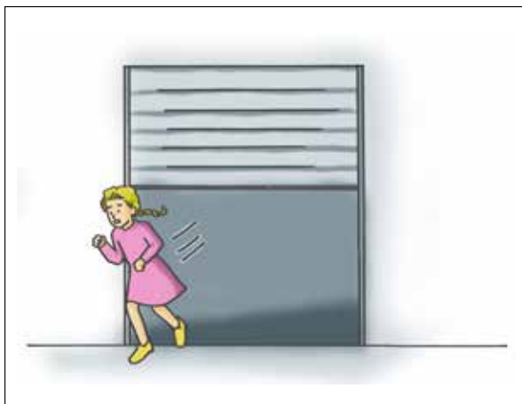
二段降下式の防火シャッターの作動（閉鎖）
