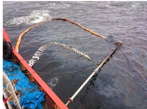
図8-8-9 吸着材フェンスと吹き流し状吸着材による油膜の回収
