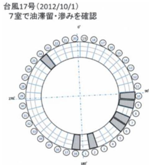
図10-4-1 浮室（ポンツーン）下板の損傷分布
