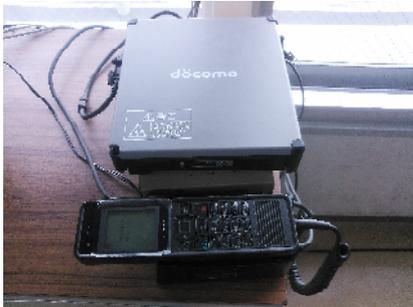
図6-3-3 衛星電話の例
