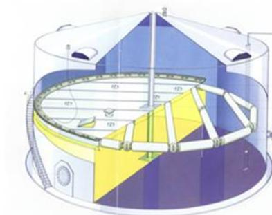
図10-5-2 内部浮き屋根タンク構造図
