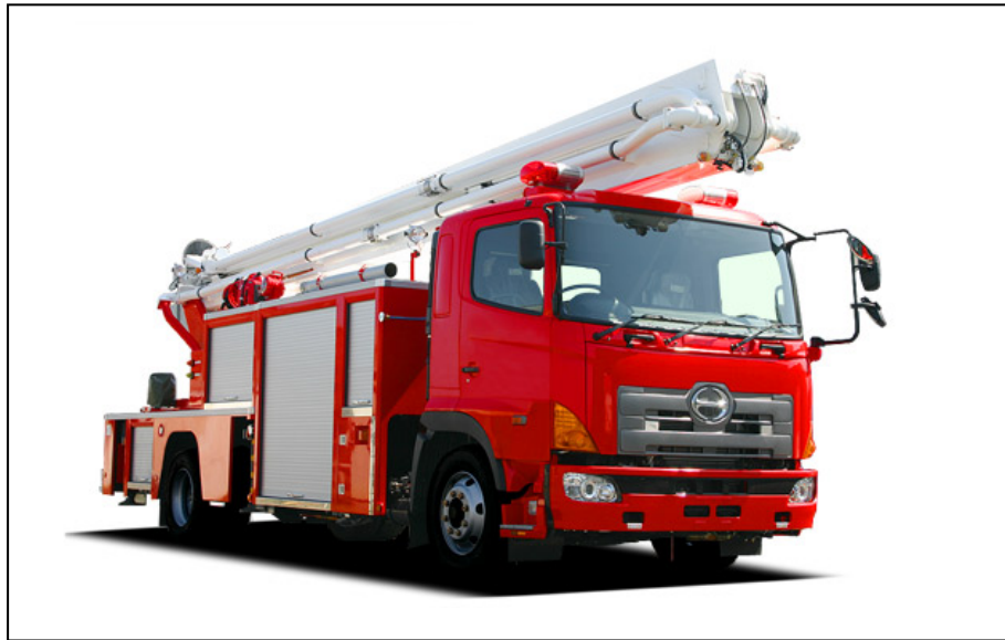
図 7 - 2 - 2 大型高所放水車
