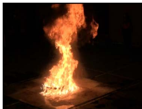
薄層ボイルオーバー発生
