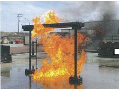
ラック配管火災を粉末消火器 (20型) 複数同時放射で消火する訓練
