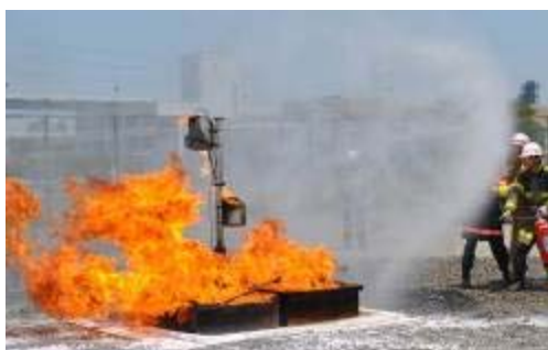
写真2-3-15 水霧による火災の制御
