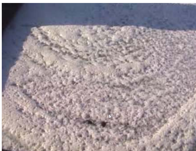
写真2-3-36 泡消火剤の消泡
