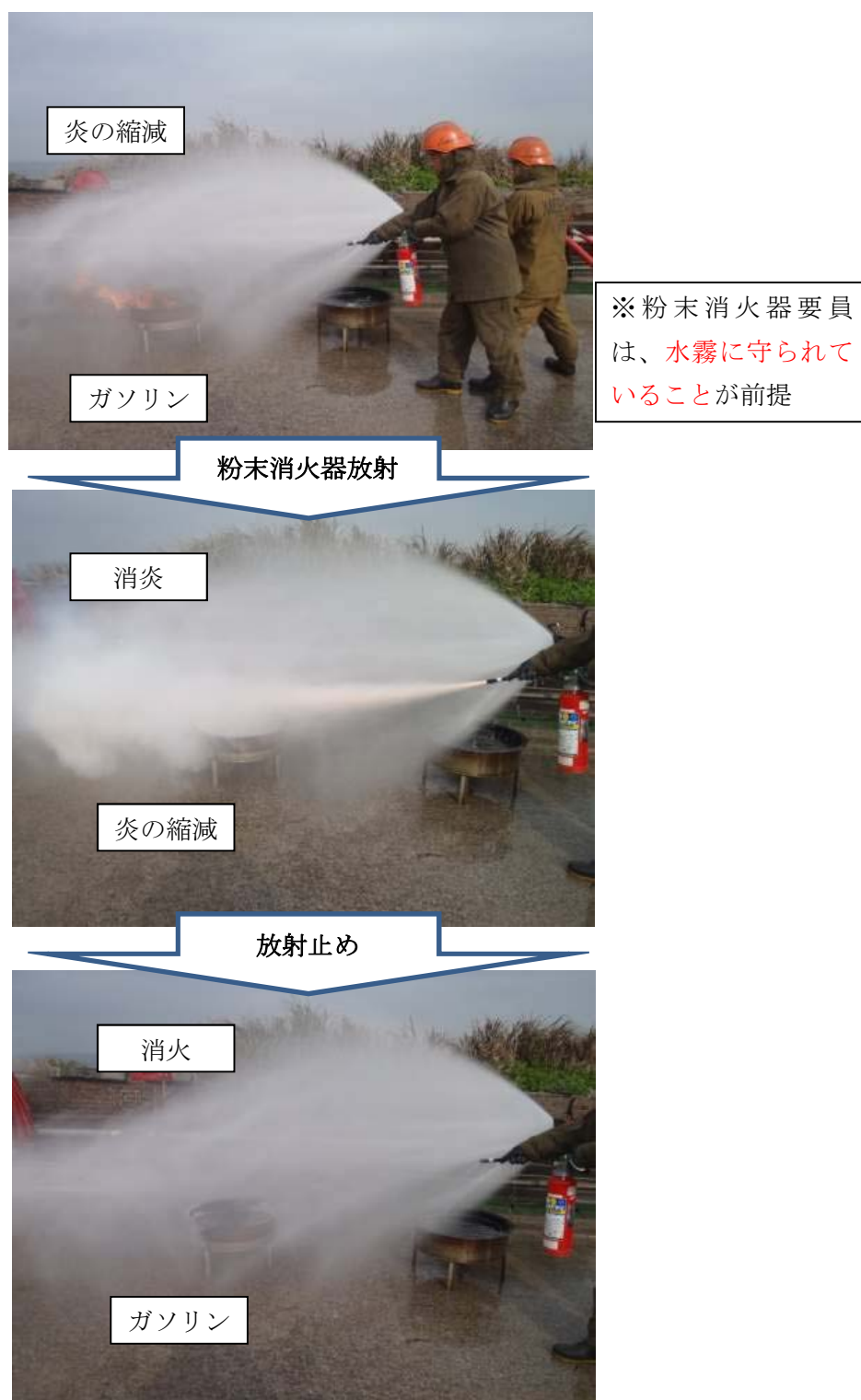
写真2-1-6 水霧放水による縮減後の粉末消火器による消炎(ガソリン)
