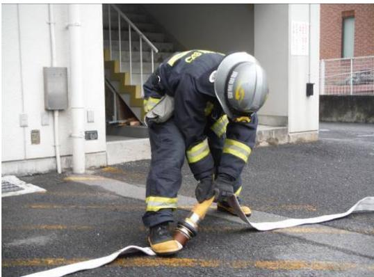
結合した後、右足でオス金具の根元を踏んだ状態で、両手で消防ホースを引っ張ってみて、結合状態を確認します。
