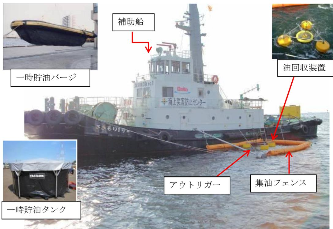
図7-12-1 補助船方式
