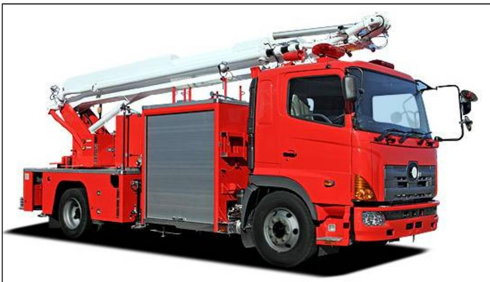
写真7-1-4 大型化学高所放水車
