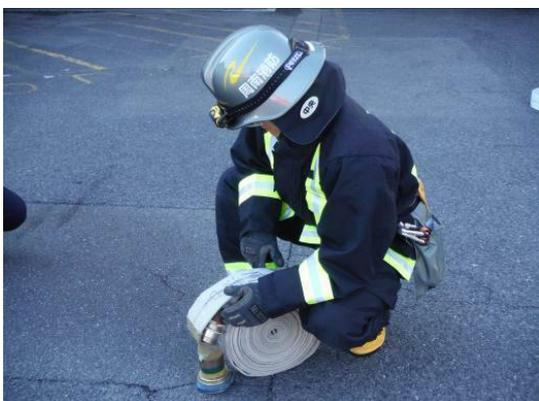
完成した二重巻き消防ホースは、オス金具とメス金具との間隔が20cm～30cm取るのが、肩に担いだときに金具が固定でき、かつ右足先でメス金具近くを踏み、オス金具を手で持ってひろげるのに適当です。
