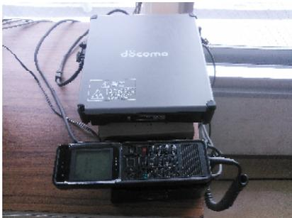
写真6-3-3 衛星電話の例
