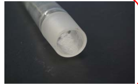
図 43 加熱発生ガス試験終了後のガス流通経路の状況(無水マレイン酸)
