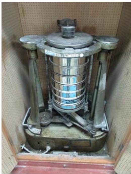
図 4 ロータップ型振とう機：化学共栄社製 RL-1(図 4)
