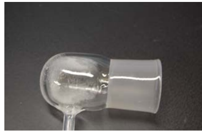
図 43 加熱発生ガス試験終了後のガス流通経路の状況(無水マレイン酸)
