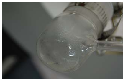
図 42 加熱発生ガス試験終了後のガス流通経路の状況(グリコール酸)
