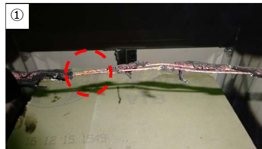
加熱後の状況（電線管なし）
