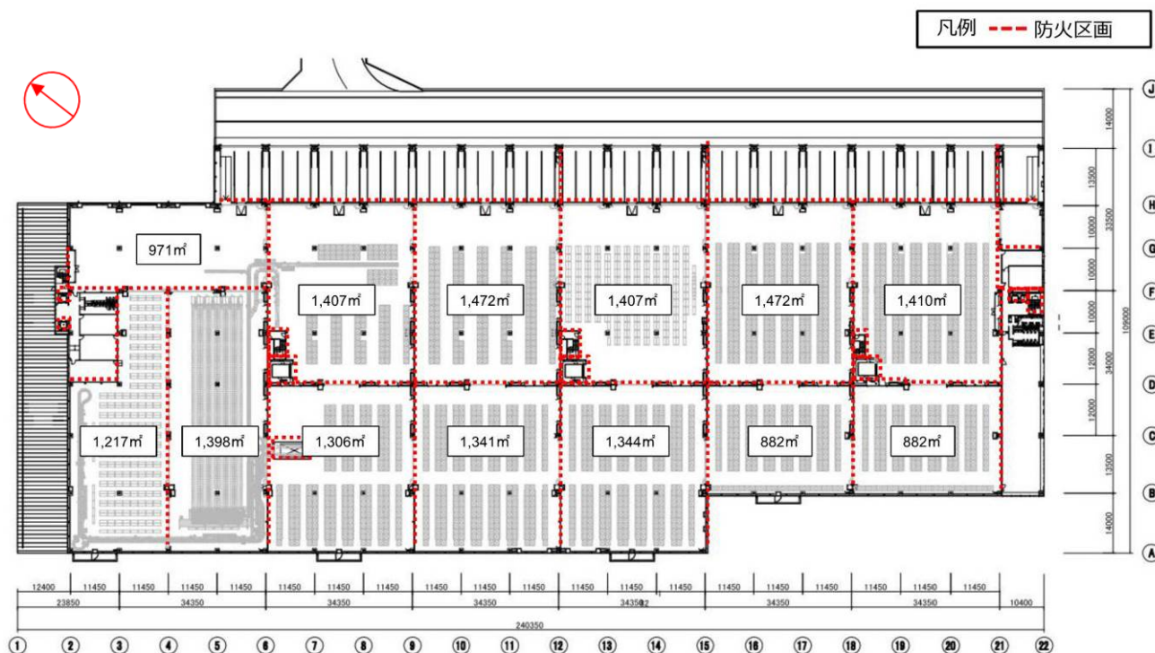
図 1-1-12 3階の防火区画と面積（灰色の線：コンベヤの敷設ライン。灰色四角：ラック）
