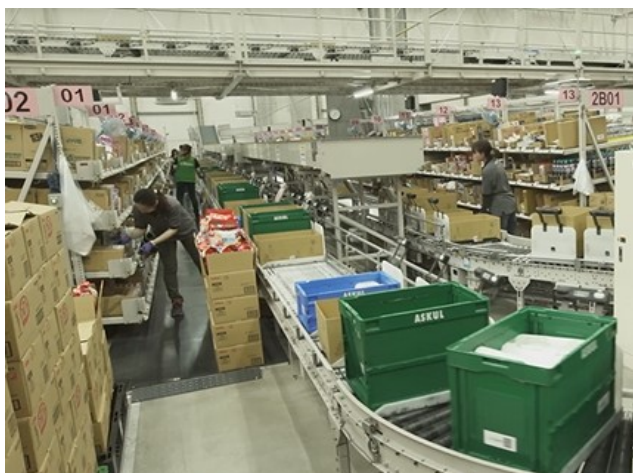
写真 1-1-4 商品棚からデジタル指示に従って商品を取り出すスペース（2階平面図③の付近）
