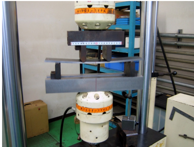
写真1 4点曲げ疲労試験(例)
