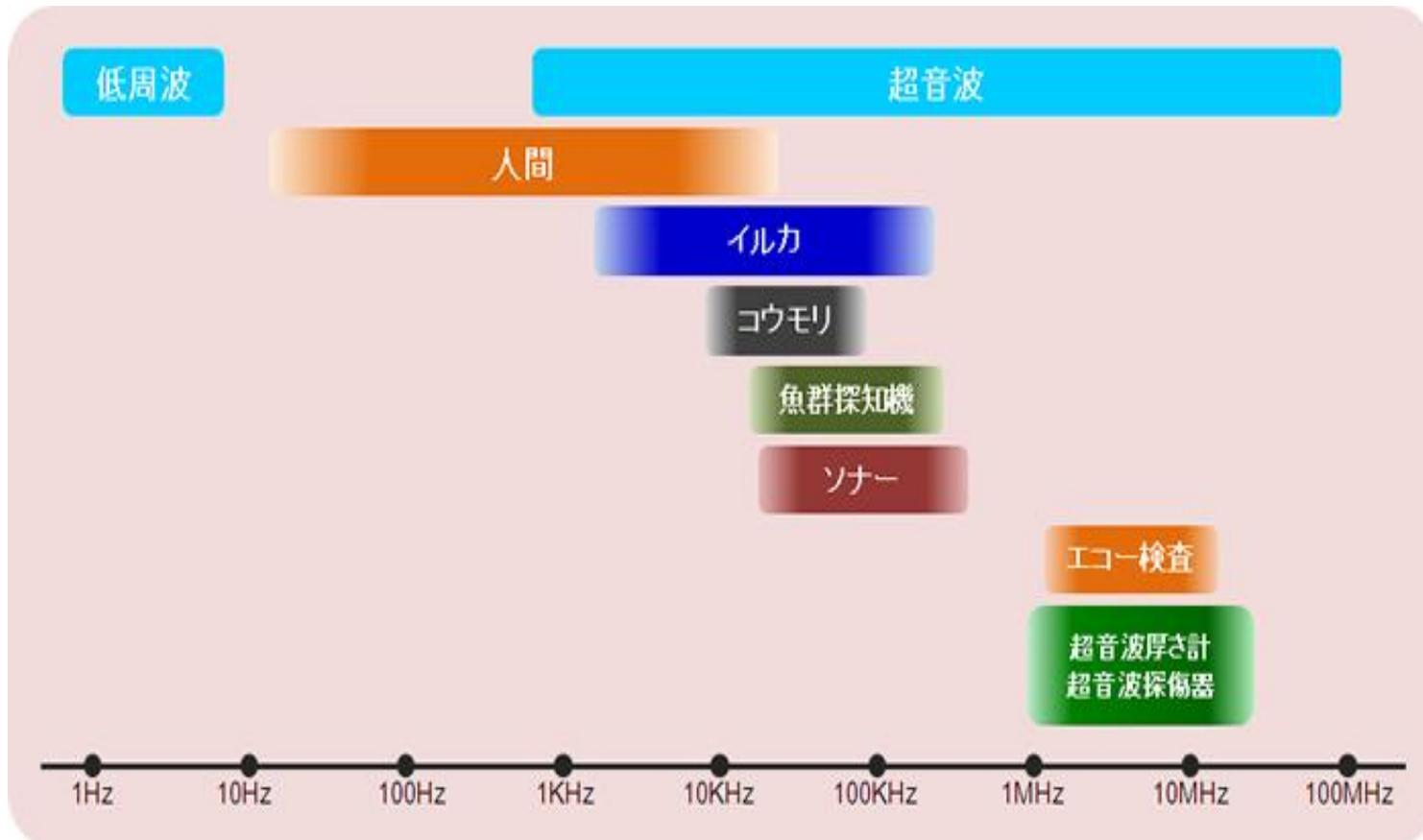
超音波探傷器は、探触子と呼ばれるセンサーから発信した超音波が、検査対象物の内部きずや反対面に反射し戻ってくる時間と強さを表示し、材料の内部の様子を計測するものです。
