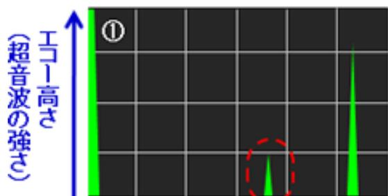
① 材料内部にきずがあるため、モニターには、きずエコーが表示される。
