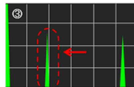
③ ①のきずと大きさは同じだが、きずの位置が探触子に近いので、エコー高さは①よりも高くなる。
