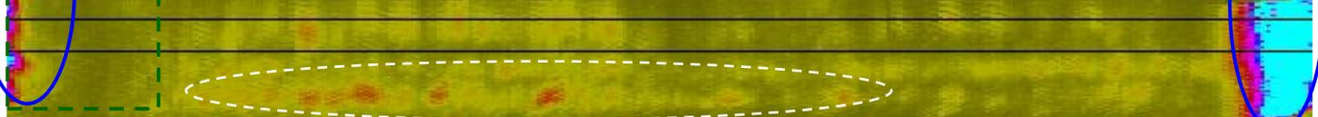
裏面近傍からの指示(2回反射)(評価対象外) 横割れきず探傷
