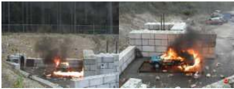
図 14 燃料電池自動車の安全弁作動時の状況 図 15 天然ガス自動車の安全弁作動時の状況
