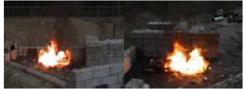
図 14 燃料電池自動車の安全弁作動時の状況 図 15 天然ガス自動車の安全弁作動時の状況
