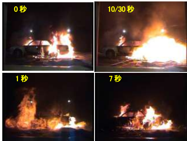
図4 車両に搭載した燃料タンクの安全弁作動時の状況
