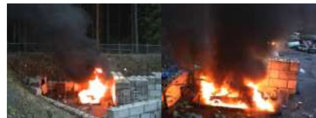
図7 ガソリンタンクに火炎が移行した時の状況
