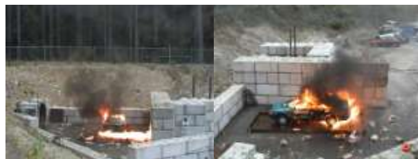
図5 水素容器搭載車の安全弁作動時の状況
