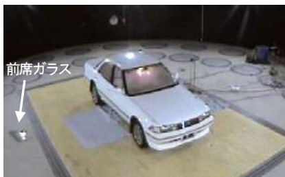
図 13 水素濃度 22%で着火させた場合の状況
