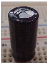
不良電解液によるコンデンサーのパック
