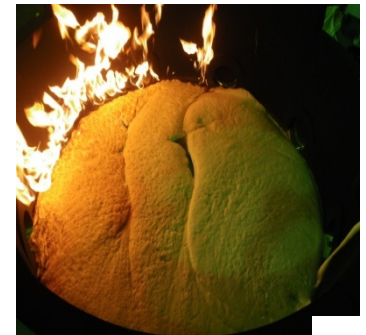
石油タンクガラス模型による泡消火時の様子(横方向・下方向・上方向からの写真)
