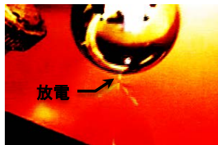
非接地導体間(球電極と液面)の放電
