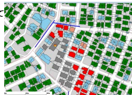
火災延焼シミュレーションの実行例
