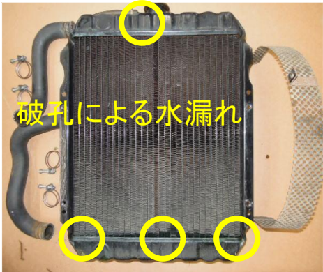
ラジエータフィンへの塵埃堆積及び破孔
