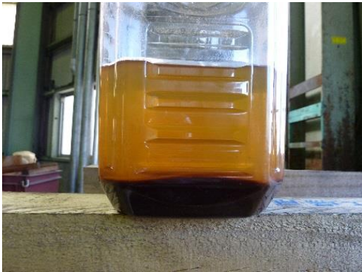
冷却水中の錆、スケール
