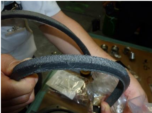
冷却ファン駆動ベルトの経年劣化で滑り発生
