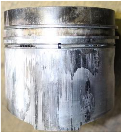
潤滑油粘度低下による油膜切れで発生したピストンの焼き付き
