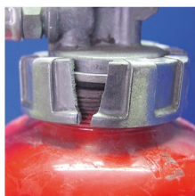
× キャップの破損
