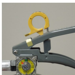
× 安全栓の抜けかけ
