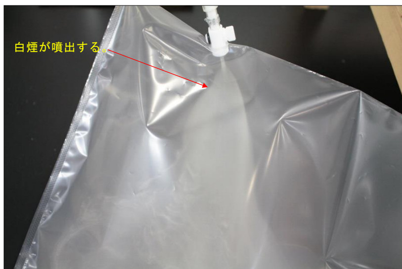
写真5 フロメトキン加熱時に発生した煙（500～800℃）
