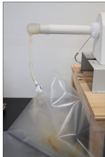
写真5 フロメトキン加熱時に発生した煙（500～800℃）
