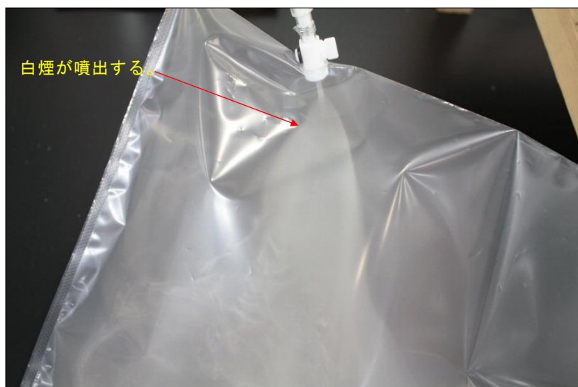
写真5 フロメトキン加熱時に発生した煙（500～800℃）
