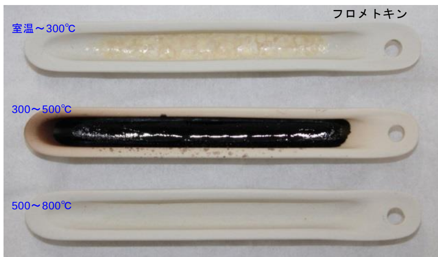
写真4 加熱後の試料
