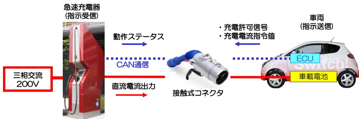
図3 急速充電(CHAdeMO方式)のしくみ
