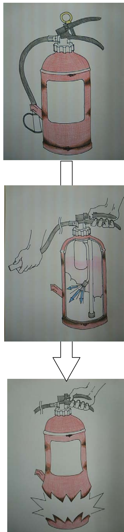
図5. 消火器破裂フロー
