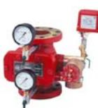
スプリンクラー設備等に使用し、スプリンクラーヘッドの作動による弁体内の流水現象を自動的に検知して弁体を開放し、信号又は警報を発する装置。
