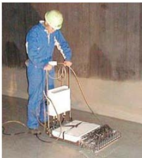
図2 タンク全面を連続板厚測定した例
