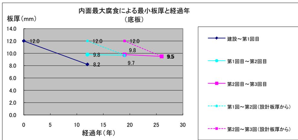
容量1万kℓ以上の新法タンクの内面腐食履歴
