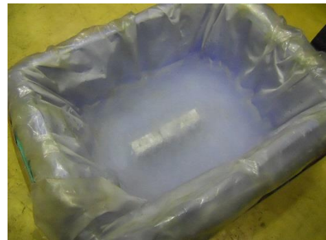
液体窒素による試験片の冷却
