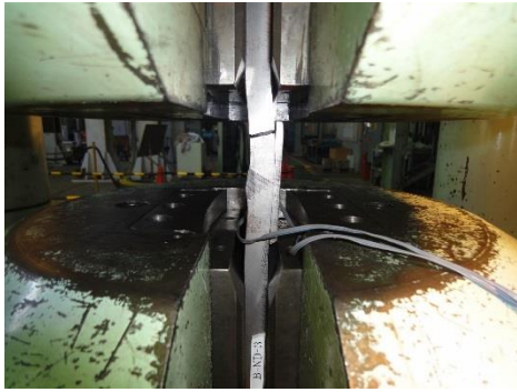
B-ND-3 破断状況(1)
