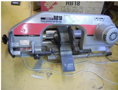
試験片の切断(1)
