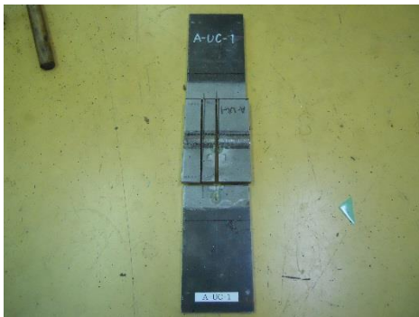
試験片切断状況
