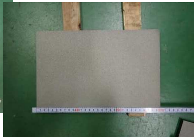
図4 表面サンドブラスト処理
