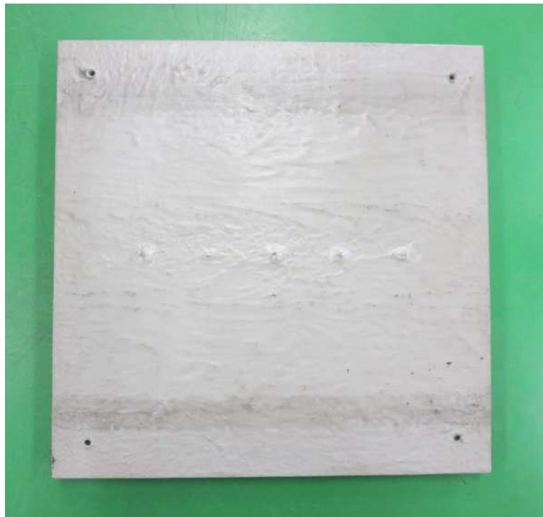
図7.4 塗装試験片(板厚12mm)
