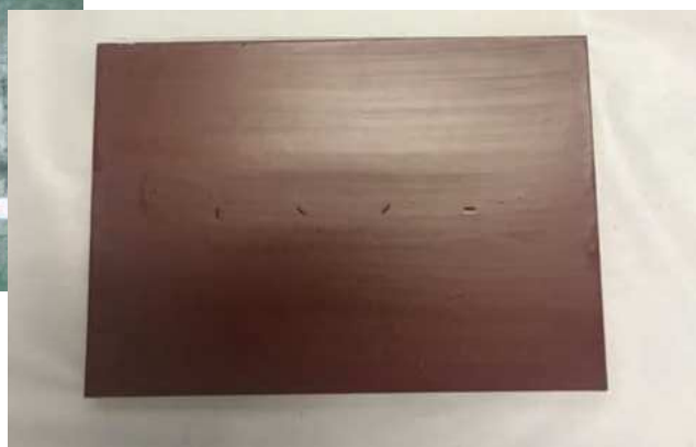
図6 下塗り後(フレイクガードプライマー)
