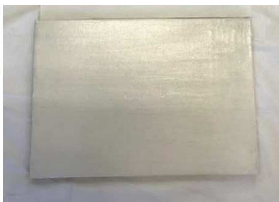
図7 中塗り後(ビニールエステルガラスフレイク)
