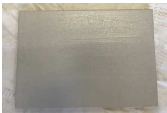
図8 上塗り後(ビニールエステルガラスフレイク)
