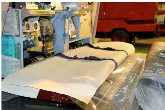
3. ストレッチャーの養生
