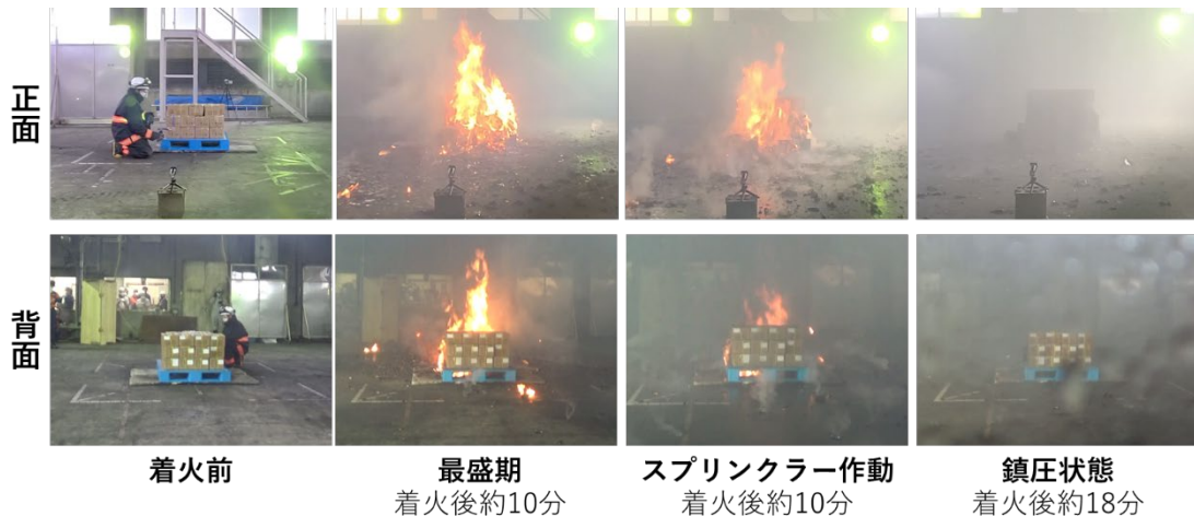
図 3-13 消火実験③の実施結果
