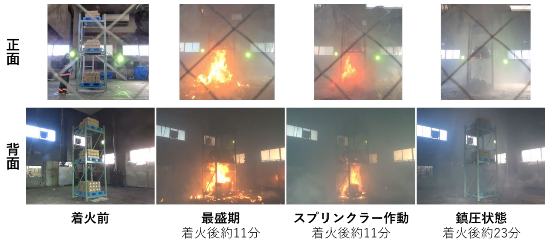
図 3-11 消火実験②の実施結果
